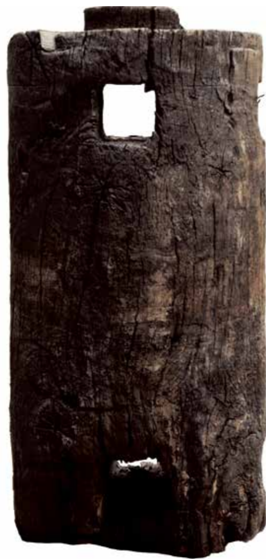
De eikenhouten braadspil na conservering. De rechthoekige uitsparingen (spaakgaten) waren met ijzeren pallen verstevigd, zodat de bij het aandrijven van de spil met een houten stok of ijzeren staaf (spaaik) de krachten gelijkmatig over het hout werden verdeeld.
